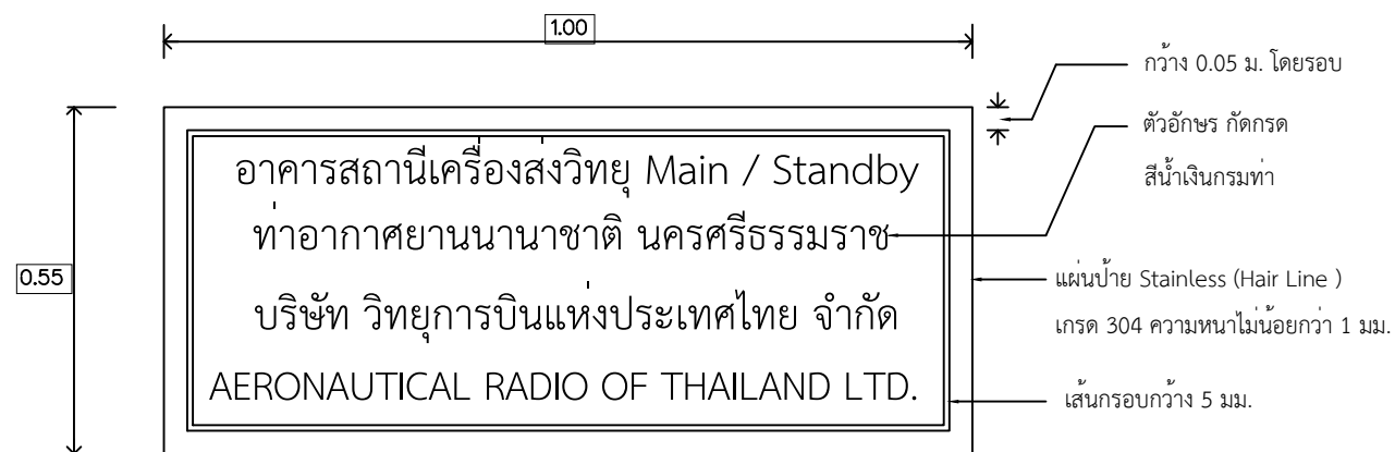
แบบงานป้ายอาคาร SCALE NTS ข้อกำหนด - ให้ผู้รับจ้าง เสนอแบบรายละเอียดป้าย เช่น แผ่นตัวอย่าง Stainless (Hair Line ) รูปแบบและขนาดตัวอักษร และสีตัวอักษร นำเสนอผู้ควบคุมงาน เห็นชอบก่อนดำเนินการ
