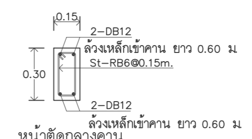
แบบขยายคาน BC1 scale 1:20
