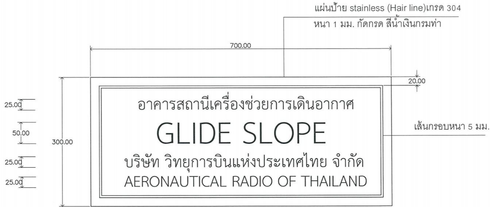
แบบงานป้ายอาคารสถานีเครื่องช่วยการเดินอากาศ GLIDE SLOPE SCALE 1:5
