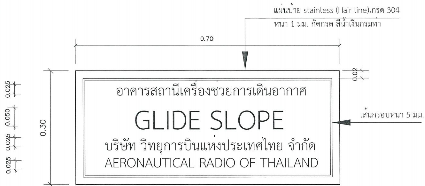
แบบงานป้ายอาคารสถานีเครื่องช่วยการเดินอากาศ GLIDE SLOPE SCALE 1:5
