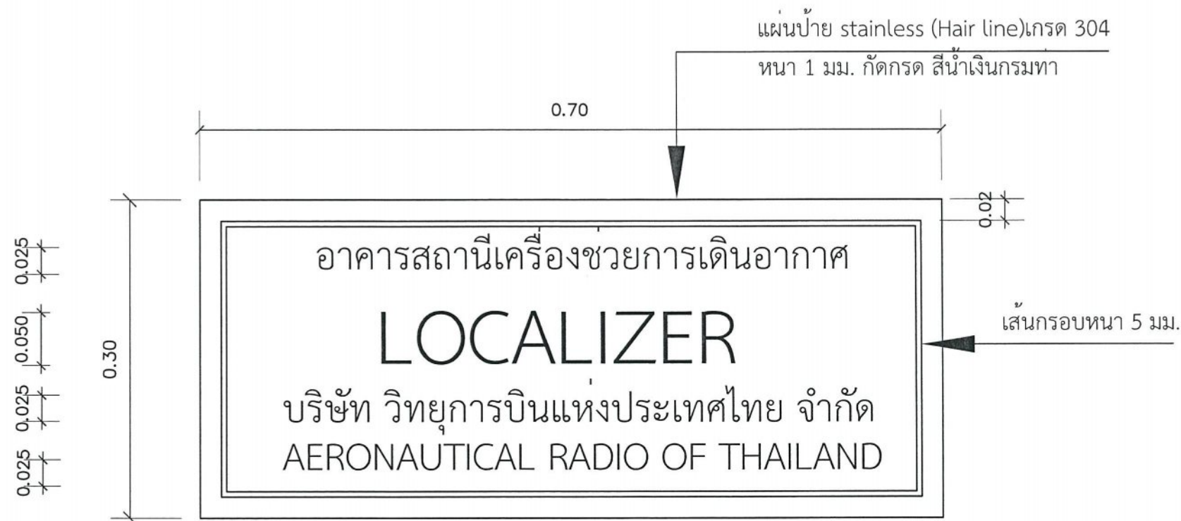
แบบงานป้ายอาคารสถานีเครื่องช่วยการเดินอากาศ LOCALIZER SCALE 1:5
