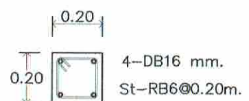
แบบขยายคาน C1/CX scale 1:20
