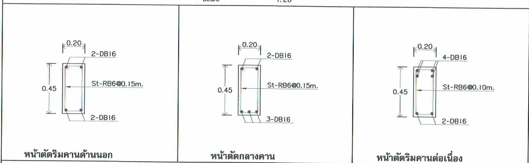
แบบขยายคาน B12 scale 1:20
